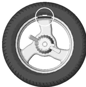
Рисунок 6.3 – Груз установлен в положение «12 часов»
