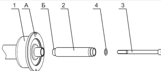
Рисунок 4.3 - Сборка вала
