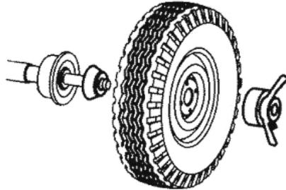
Рисунок 6.5 – Установка колеса
