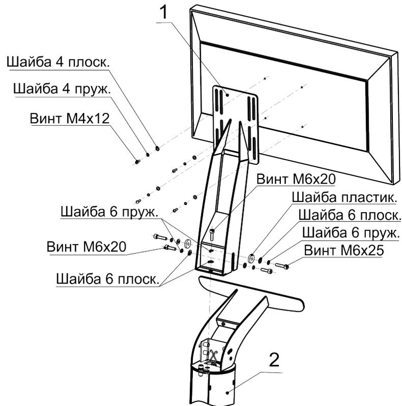
Рисунок 4.7 - Установка монитора
