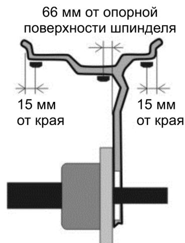
б – для грузовых колес диаметром более 20"
