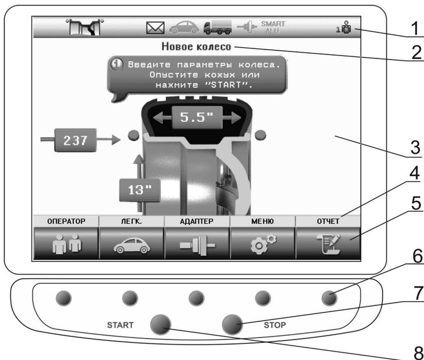
1-информационное поле; 2 – наименование состояния; 3 – основное поле; 4 – панель наименований клавиш; 5 – обозначения многофункциональных клавиш; 6 – многофункциональные клавиши; 7 – клавиша остановки вращения вала; 8 – клавиша запуска вращения вала и измерения дисбаланса
