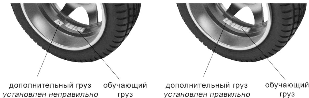
Рисунок 7.2 – Положение дополнительного груза
