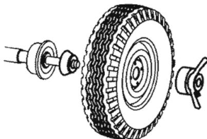
Рисунок 6.1 – Установка колеса
