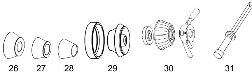
Рисунок 3.2 – Комплект №1 для установки легковых колес (по заказу)
